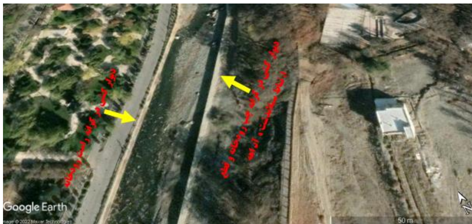
شکل ۸. تصویر احداث دیواره در کرانه راست و چپ رودخانه و قطع پیوستگی سیلاب‌دشت با آبراهه در بازه شماره ۴، منبع: تصاویر
