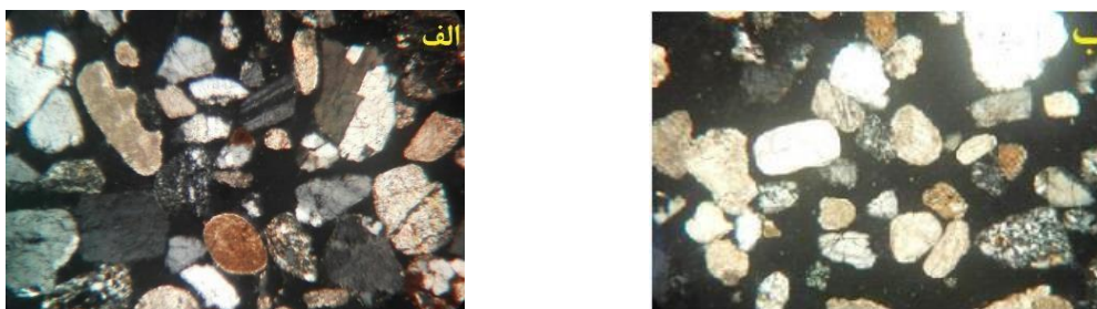
شکل ۴: مورفوسکوپی مقاطع نازک تهیه شده از رسوبات بادی نمونه اول (الف) و نمونه دوم (ب) با استفاده از میکروسکوپ پلاریزان (مقیاس ۲ میلی‌متر)
