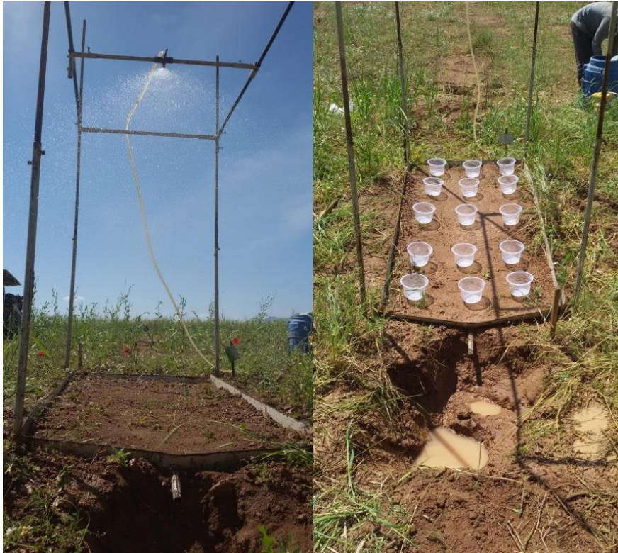
شکل ۲. نمایی از شبیه‌ساز باران در مزرعه آموزشی و پژوهشی دانشگاه رازی (چپ)، واسنجی مجدد باران‌ساز در منطقه مورد نظر (راست) میزان حجم رواناب هر بطری با استفاده از استوانه مدرج و مقدار بار رسوب معلّق از طریق روش برجاگذاری (شریفی مقدم و همکاران، ۱۳۹۳) محاسبه شد. برای برآورد ضریب رواناب، کلّ حجم رواناب خروجی در هر فاصله زمانی بر کلّ حجم بارندگی که سطح پلات در این مدت دریافت کرده است، تقسیم شد. نمونه‌های خاک سطحی (۳۰-۰ سانتی‌متر) در کنار هر پلات از منطقه مورد نظر گرفته و ویژگی‌های مختلف فیزیکی و شیمیایی آن در آزمایشگاه تعیین شد.
