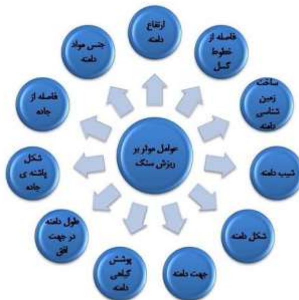
شکل ۷. عوامل مؤثر بر ریزش سنگ در جاده حمیل - سرابله
