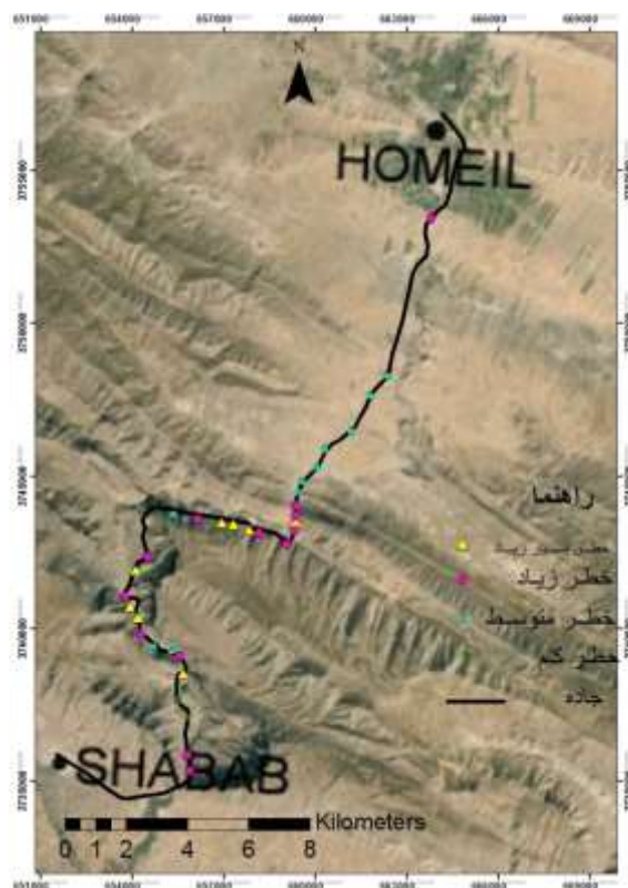
شکل ۸. مکان های ریزشی بر روی جاده حمیل - سرابله به تفکیک میزان خطر
